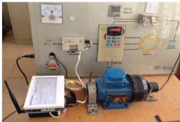
H.11 Mô hình thực tế thử nghiệm bảo mật Modbus TCP
