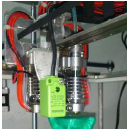
H. 11 Cảm biến tiệm cận dùng để đo độ lệch của bàn máy
