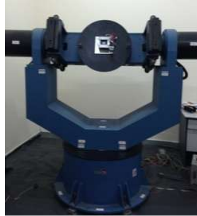
Hình 5: Thử nghiệm trên bàn xoay 3 bậc tự do
