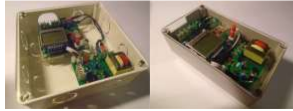
H.9 Thiết bị đo và giám sát điện năng không dây phiên bản 1a (a) và phiên bản 1b (b)
