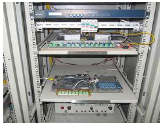
H. 3 Bố trí Board DAQ cùng mạch xử lý tín hiệu trên khay theo tiêu chuẩn 19U
