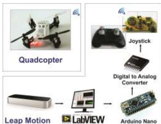
H. 12 Sơ đồ hệ thống điều khiển Nano Quadcopter với Leap Motion
