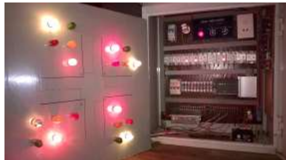
H.10 Mô hình một nút điều khiển đèn THGT
