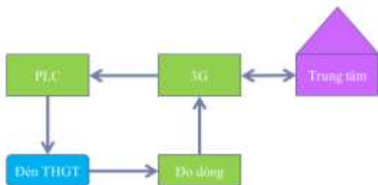
H.2 Nguyên lý điều khiển và giám sát hệ thống
