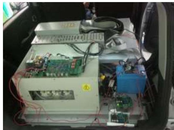
H. 16 Bộ nghịch lưu và bộ điều khiển dSPACE được lắp đặt ở vị trí băng ghế sau của ô tô
