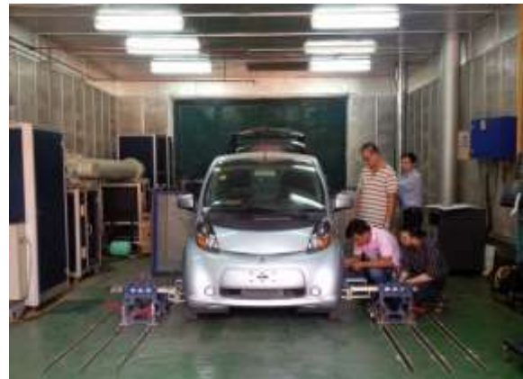
H. 15 Ô tô điện i-MiEV trên hệ thống băng thử tải
