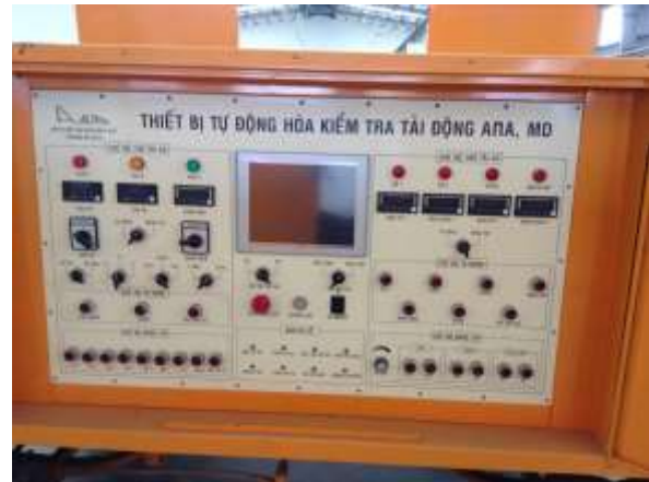
H.11. Thiết bị thử tải tự động APA.
