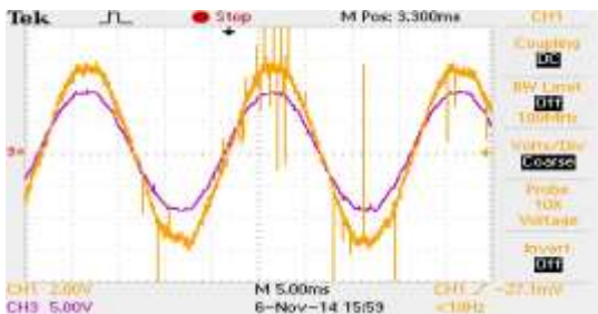
Hình 20. Áp và dòng điện ngõ vào khi áp dụng kỹ thuật triệt tiêu áp common mode
