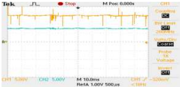
Hình 19. Điện áp trên tụ- kỹ thuật triệt tiêu áp common mode
