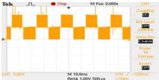
Hình 21. Điện áp trên tải khi áp dụng kỹ thuật triệt tiêu điện áp common mode.
