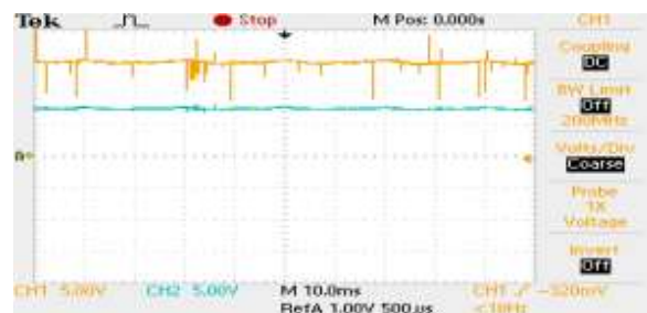
Hình 17. Điện áp trên các tụ DC khi áp dụng kỹ thuật PWM thông thường
