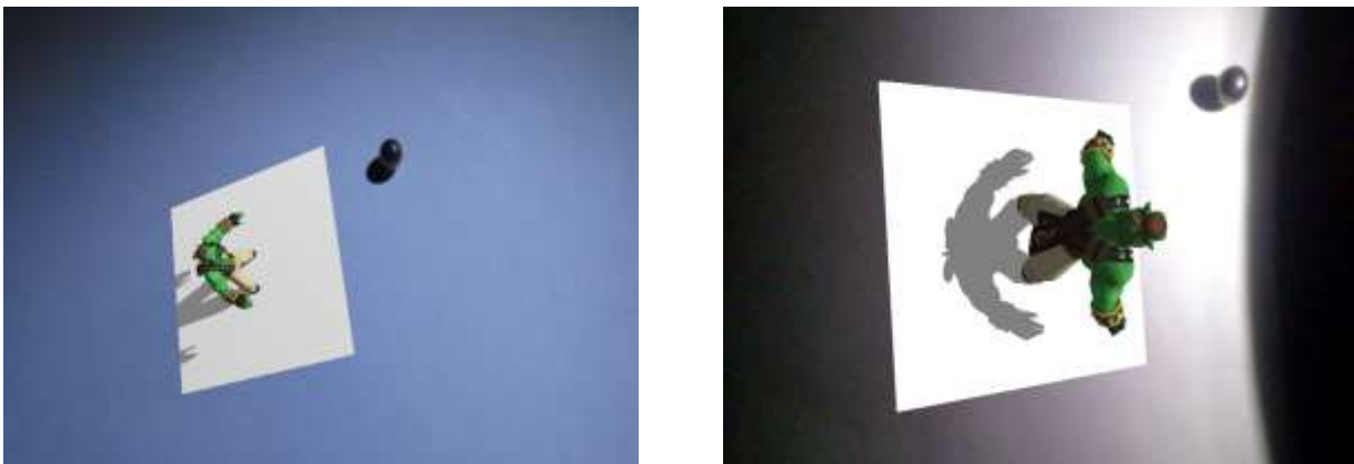
Hình 4. Đối tượng 3D được chèn vào hệ thống, bóng của đối tượng được đối sánh với bóng của quả cầu
