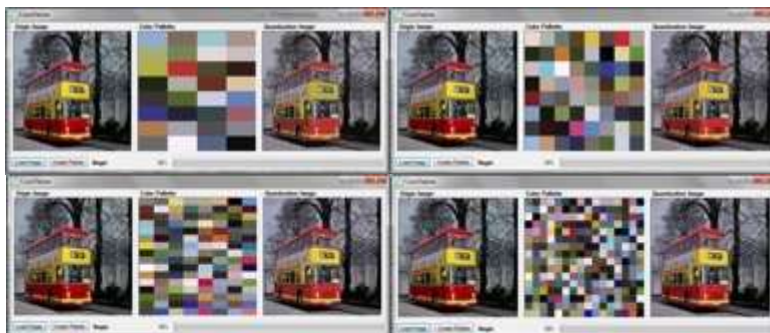
Hình 1. Các dải màu để lượng tử hình ảnh, gồm: 32 màu, 64 màu, 128 màu và 256 màu
