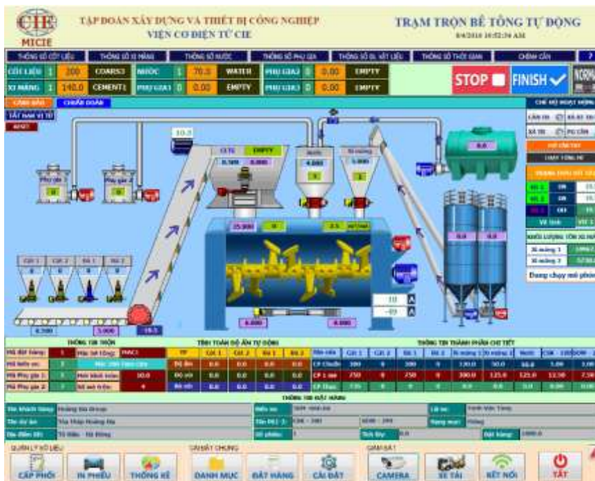
Hình 8. Phần giám sát và điều khiển cho kỹ sư điều khiển tại trạm
