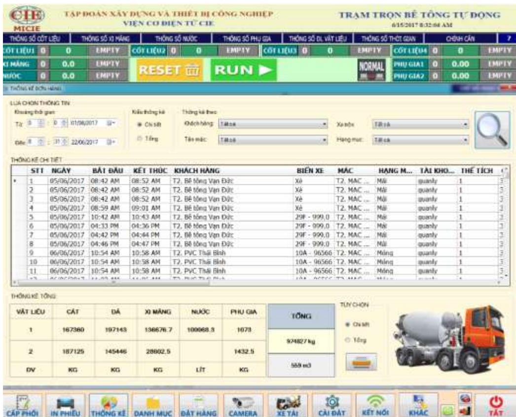
Hình 10. Chức năng quản lý thống kê cho kỹ sư điều khiển tại trạm
