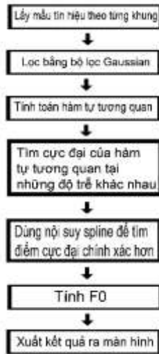
Hình 2. Sơ đồ khối thuật toán tìm cao độ tín hiệu đàn ghi-ta
