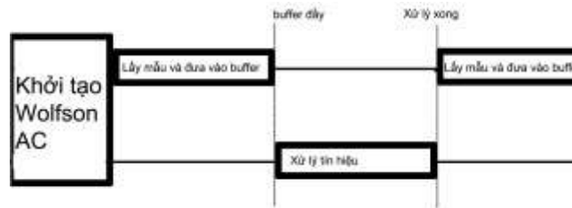
Hình 3. Sơ đồ khối lấy mẫu và xử lý tín hiệu
